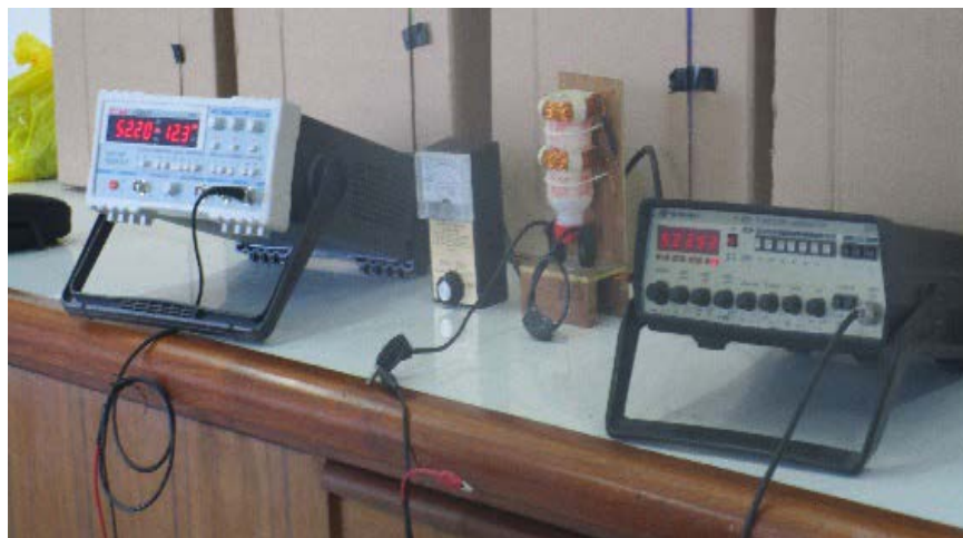
Fotografía N°2 Disposición de los equipos, generadores, medidor de campo de inducción magnética en miliGauss y bobina en el Laboratorio de Física Aplicada de la Facultad de Ciencias Biológicas.
