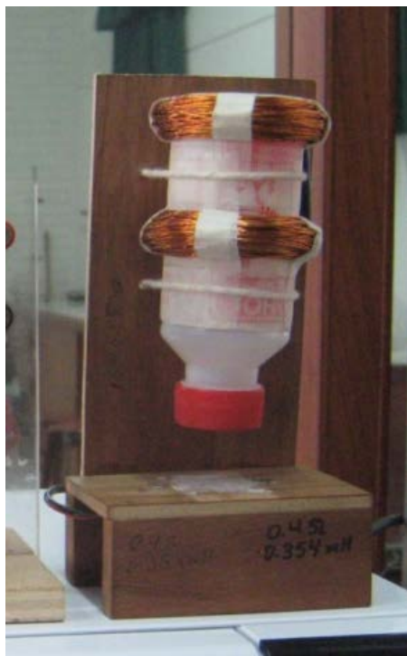
Fotografía N°1 Bobina de Campo Magnético tipo Helmholtz diseñada por el Profesor Iván Ramírez J. en el Laboratorio de Física Aplicada de la Facultad de Ciencias Biológicas.
