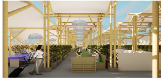
Vista interior: estructura de bambú, membrana geotextil y mesas de descanso con madera reciclada.
