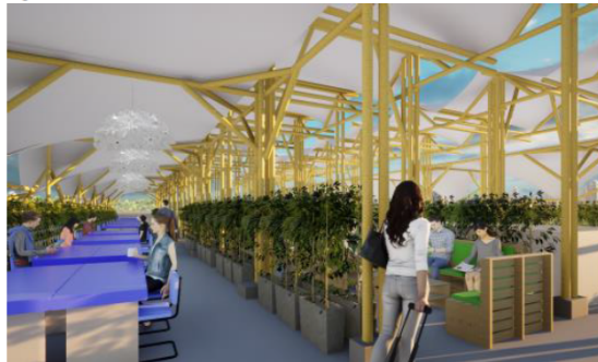
Vista interior: estructura de bambú, membrana geotextil y mesas de descanso con madera reciclada.
