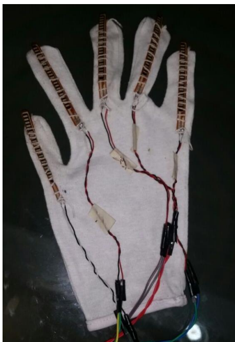
Figura 8: galgas extensiométricas acopladas a un guante
