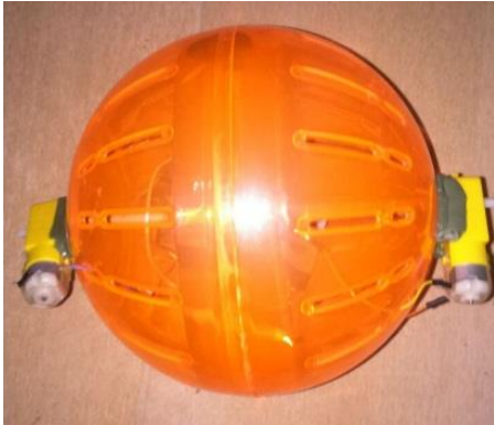
Figura 9. Robot móvil de acrílico
