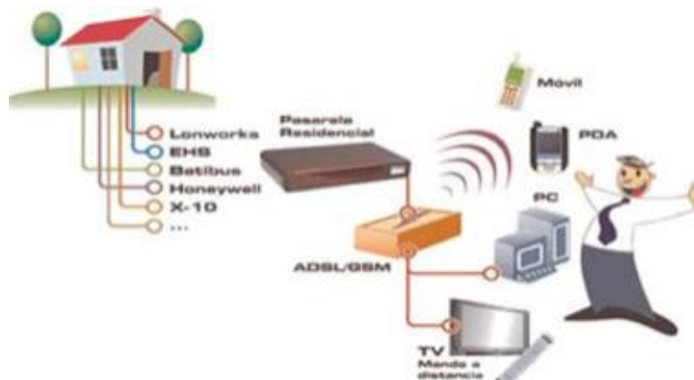
Figura°4: Distribución de un domicilio aplicando domótica
