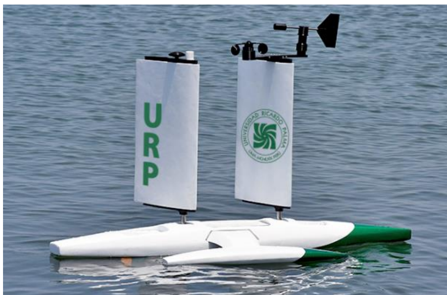
Foto 7: Diseño final del velero sin tripulantes manejado desde tierra: proyecto PATHFINDER
