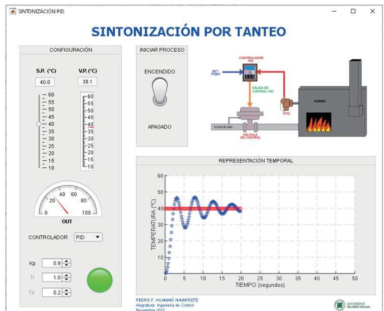
Figura 32. Simulador de sintonización de un Control PID por Tanteo para temperatura, en Matlab.
