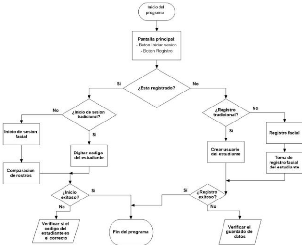
Fig 5. Diagrama de flujo para la gestión del acceso estudiantil en la URP
