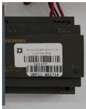
Figura N° 4: Fuente de Alimentación Estabilizada LOGO! Power 24 V / 4 A
