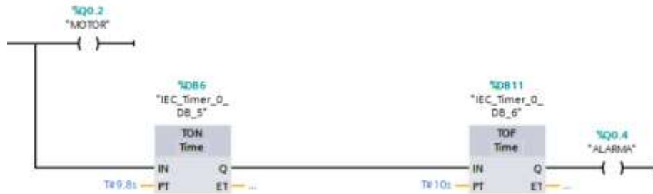
Figura N° 10: Programación Ladder en TIA PORTAL V14
