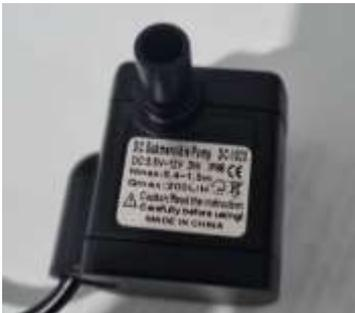
Figura 2: Especificaciones técnicas de mini bomba. Fuente: Toma propia.
