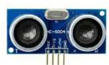
Figura 4: Sensor de ultrasonido HC-SR04 Fuente: Extraída de [7]
