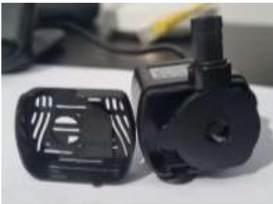
Figura 3: Bomba sumergible sin canastilla. Fuente: Toma propia.
