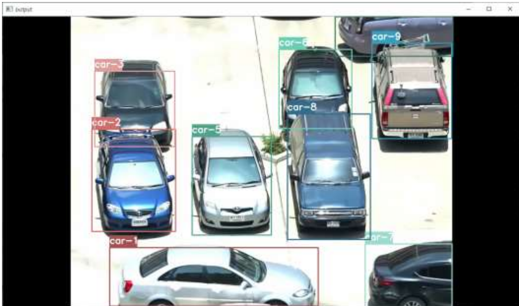
Figura 10: Detección de los vehículos en el video así como la asignación de sus ID. Fuente: Elaboración propia.
