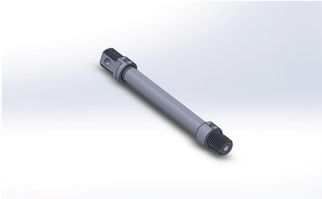
Figura 19: Cilindro electropneumático en 3D Fuente: Elaboración propia
