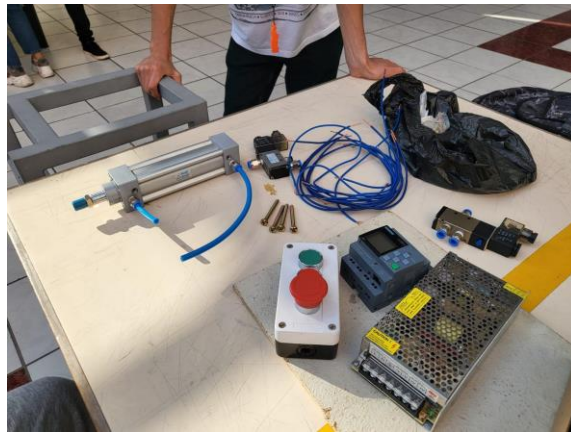
Figura 25: Componentes para la elaboración del proyecto: PLC, Piston, Fuente de poder, botonera y electroválvulas.
