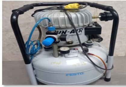
Figura 14: Compresora de aire comprimido
