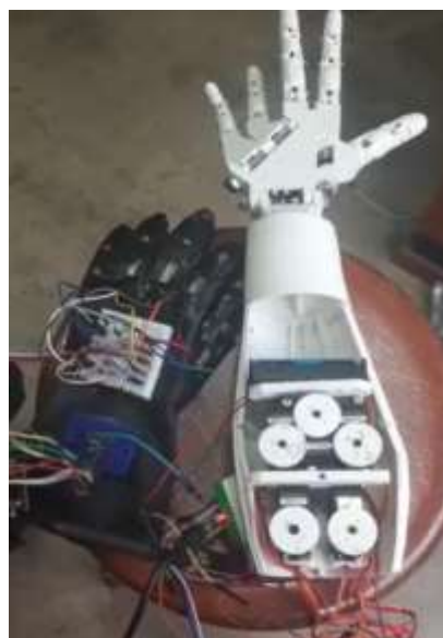
Figura 1: Proyecto ensamblado (Guante y brazo robótico)
