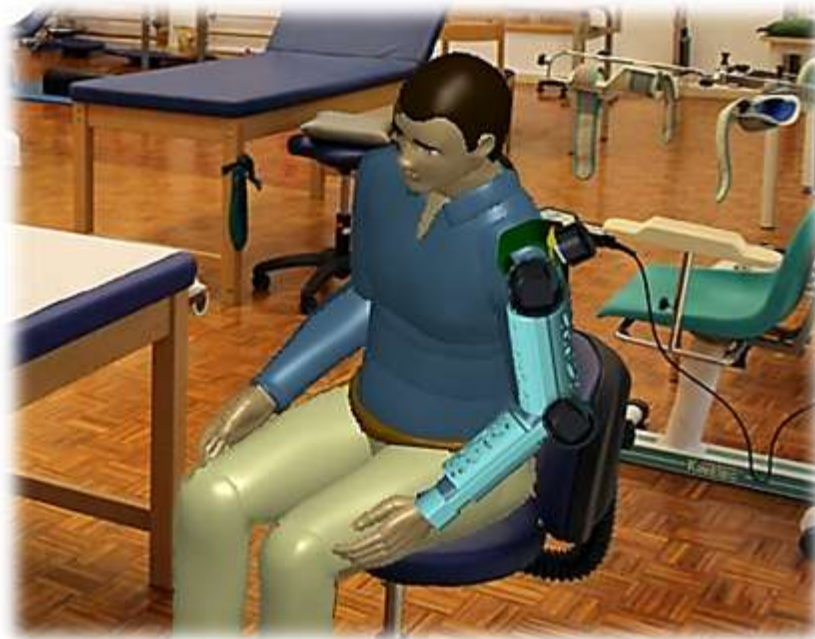
Figura 1. Exoesqueleto 3D para rehabilitación en extremidad superior.
