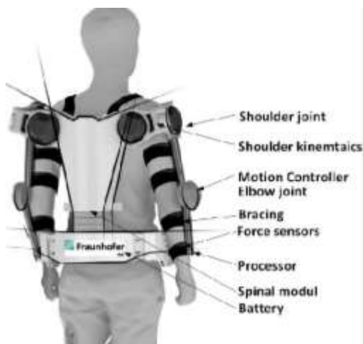
Figura 15. Articulaciones del Exoesqueleto.
