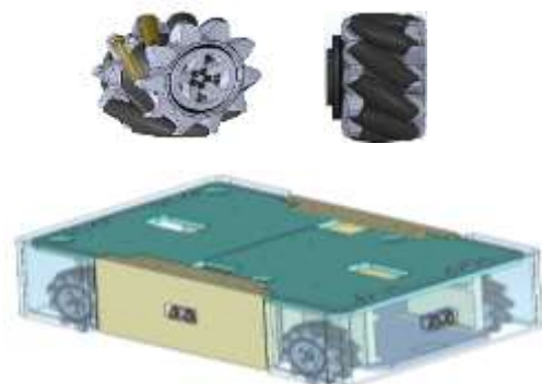
Fig. 2. Ruedas Mecanum y Ensamble de la base móvil del robot
