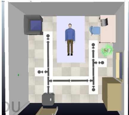
Fig 5. Ruta aproximada de la parte móvil del robot
