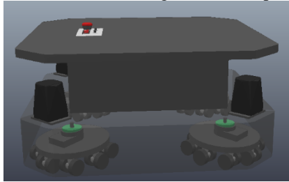
Fig 10. Robot móvil con plataforma omnidireccional
