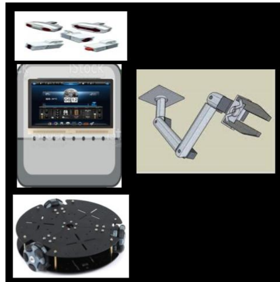
Fig. 3. Esquema del diseño del robot (sensores, cuerpo lógico del robot con una pantalla, brazo del robot y parte móvil del robot)
