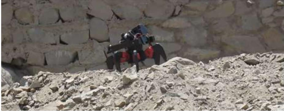
Figura 10. Robot hexápodo realizando búsqueda de personas
