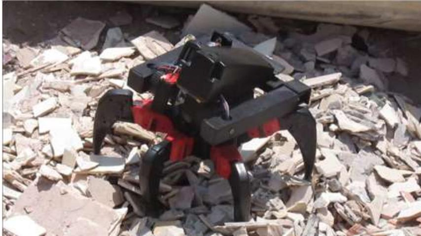
Figura 8. Prueba de estabilidad del robot
