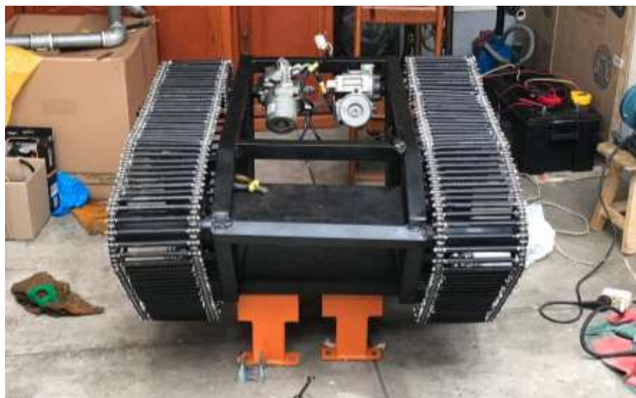
Figura 7.2 Fajas de oruga del robot Fuente: Elaboración propia
