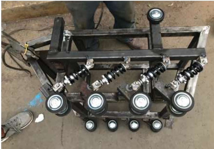
Figura 61: Tensores para la faja de oruga Fuente: Elaboración propia.
