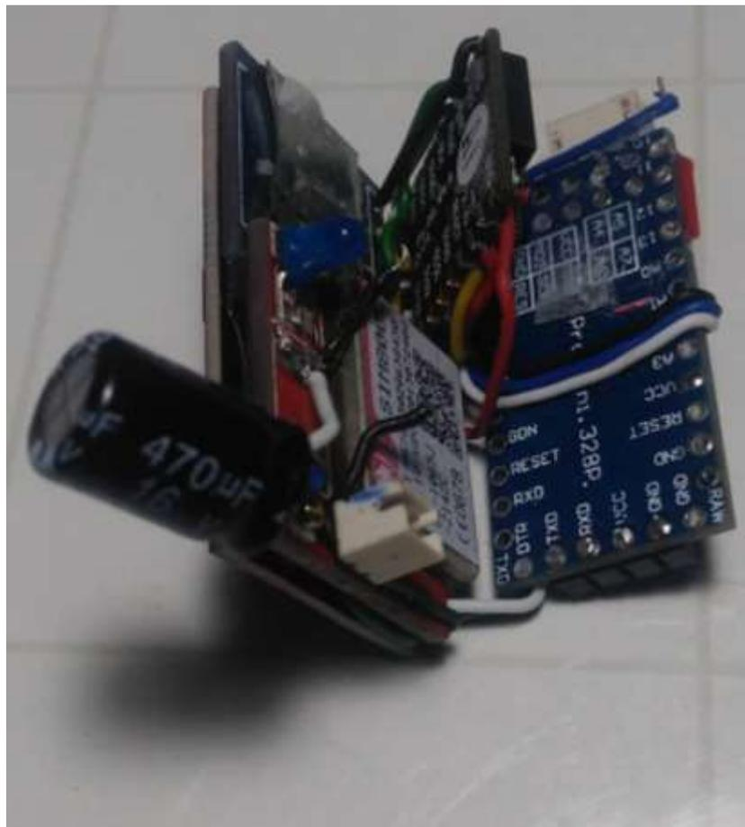
Disposición de todos los módulos utilizados y su cableado interno sin usar placa galleta
