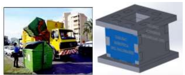
Figura3: Contenedor de carga lateral (3200 litros), y de servicio con camión recolector-compactador de carga lateral / Diseño en SolidWorks del contenedor usado en el proyecto
