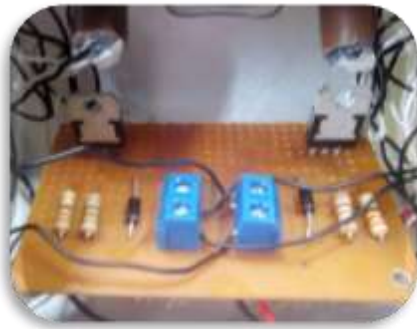
Imagen 12. Placa galleta con los elementos ya soldados.
