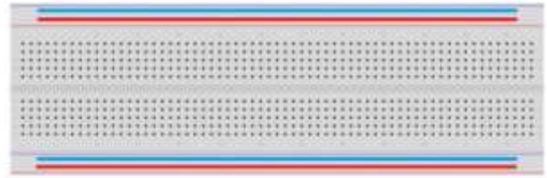
Imagen 1. Protoboard señalando las partes de alimentación. Recuperado de: https://tuelectronica.es/que-es-la-protoboard/
