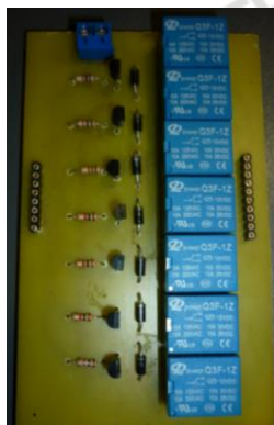
Figura 9. Interface de Conmutación
