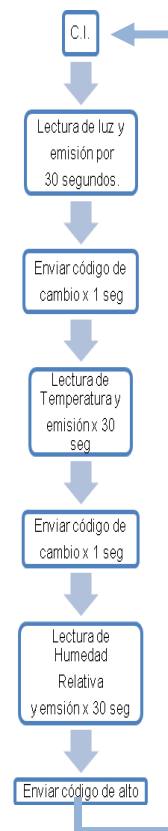
Figura 6. Flujograma de funcionamiento de Arduino. El algoritmo de programación del Arduino se configura para que realice una lectura analógica del voltaje de referencia que ingresa al 'analog port' 5 y éste lo lleva a un digital converter de 10 bits. Esto significa que mapeará los voltajes de entrada entre 0 y 5 voltios en valores enteros entre 0 y 1023. Generando una resolución de 0.0049 volts (4.9mV) por
